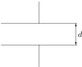
Плоский конденсатор (в разрезе)
